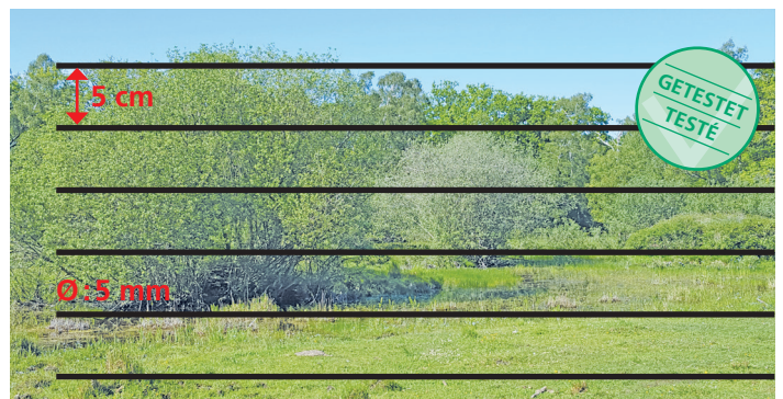
Illustration 5: Généralement bien acceptés, les marquages composés de lignes noires verticales ou horizontales sont très efficaces dans le cas des vitrages transparents tels que les parois antibruit et coupe-vent, les passerelles ou les cages d'ascenseur. Si l'arrière-fond est souvent plutôt sombre, il est recommandé d'utiliser des lignes blanches, orange ou de couleur cristal ou métal. © Station ornithologique suisse
